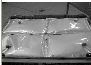
Figure 4 Chargement maximum de poches grand format, avec 5 capteurs autonomes de températures (Panier vu de dessus)
