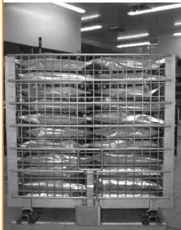
Figure 5 Plan de chargement maximal en poches grand format (panier vu de profil)
