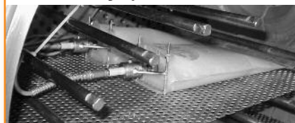
Figure 2 Sachets Doypack® équipés de sondes filaires de température, maintenues avec le dispositif conçu pour l'étude.
