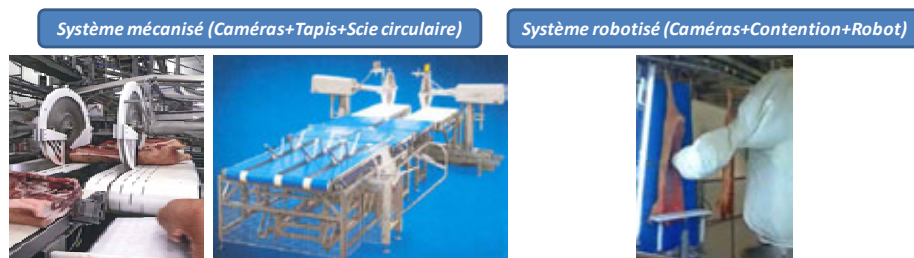
Fig. 2 : Exemples de solutions existantes pour la découpe primaire des demi-carcasses de porcs
