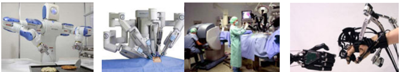
Fig. 16 : Exemples de solutions multi-bras robotiques : d'un humanoïde de la société MOTOMAN (à gauche), d'un système télémanipulé multi-bras robotiques pour la chirurgie, le système Da VINCI (au centre), et la télémanipulation d'une main droite robotique de la société SHADOW (à droite)
