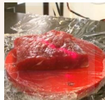
Figure 8 : Recouvrance (retrait rapide de la pointe grâce aux électroaimants et suivi laser de la position du tissu au cours du temps.)
